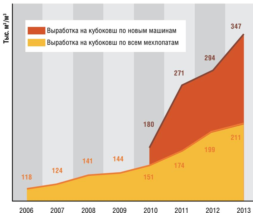
Динамика выработки на кубоковш экскаваторов-мехлопат, м<sup>3</sup>/м<sup>3</sup>
