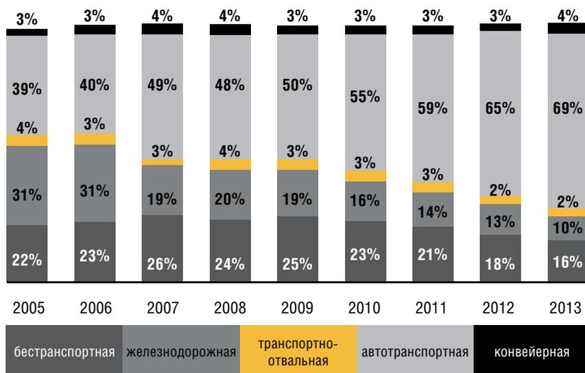
Доля различных способов транспортировки в общем объеме перемещаемой горной массы, %
